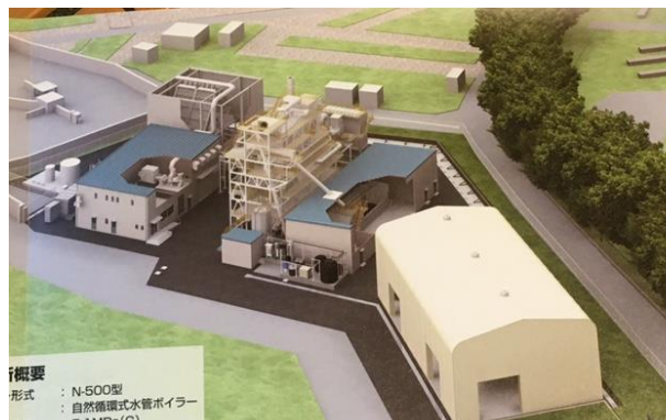
発電所全景 中央：蒸気発生ボイラー 左建屋内：蒸気タービン発電機 手前：剪定枝供給エリア
